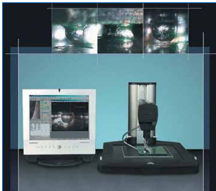
Рис. 7. Оптическая система VPI-1000 для контроля качества паяных соединений шариковых выводов
