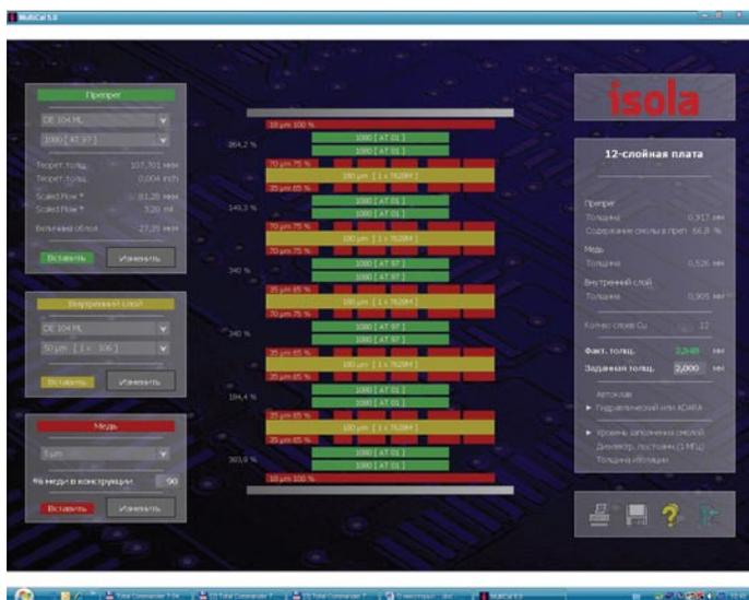
Рис. 1. Экран расчета результирующей толщины и достаточности смолы калькулятора MultiCal 5.2
